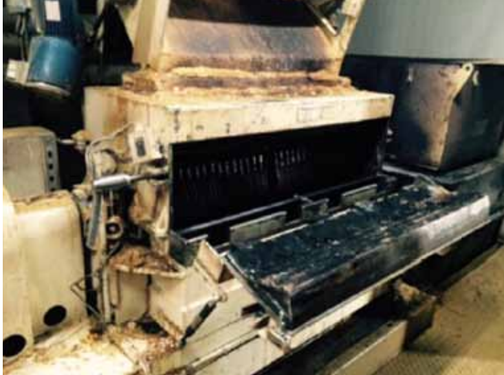
Brand in de maalkamer van een hamermolen. De materiële schade bedroeg 150.000 euro, de schade als gevolg van bedrijfsstilstand 850.000 euro.
